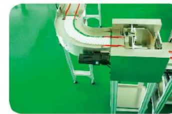
链板式散面拐弯 自动整齐理料机
